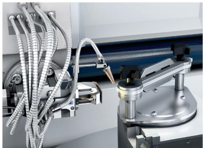
Nahtschweißen mit Schwenk- und Drehachse.
