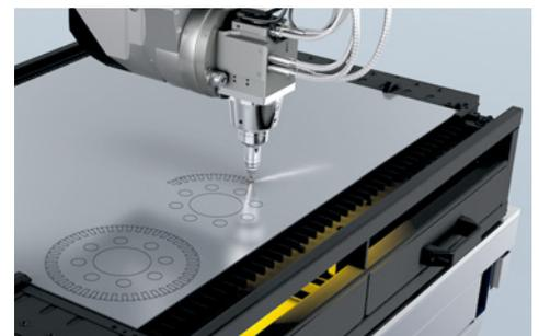
2-D-Laserschneiden von Statorblechen.
